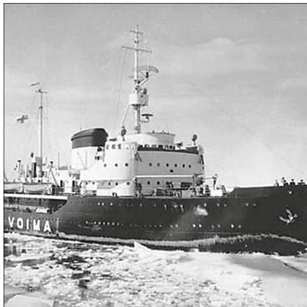
Jäänmurtaja Voima, Hartolan Voiman kaima vuonna 1954. Voima oli valmistuessaan maailman ensimmäinen kahdella keulapotkurilla varustettu jäänmurtaja.
