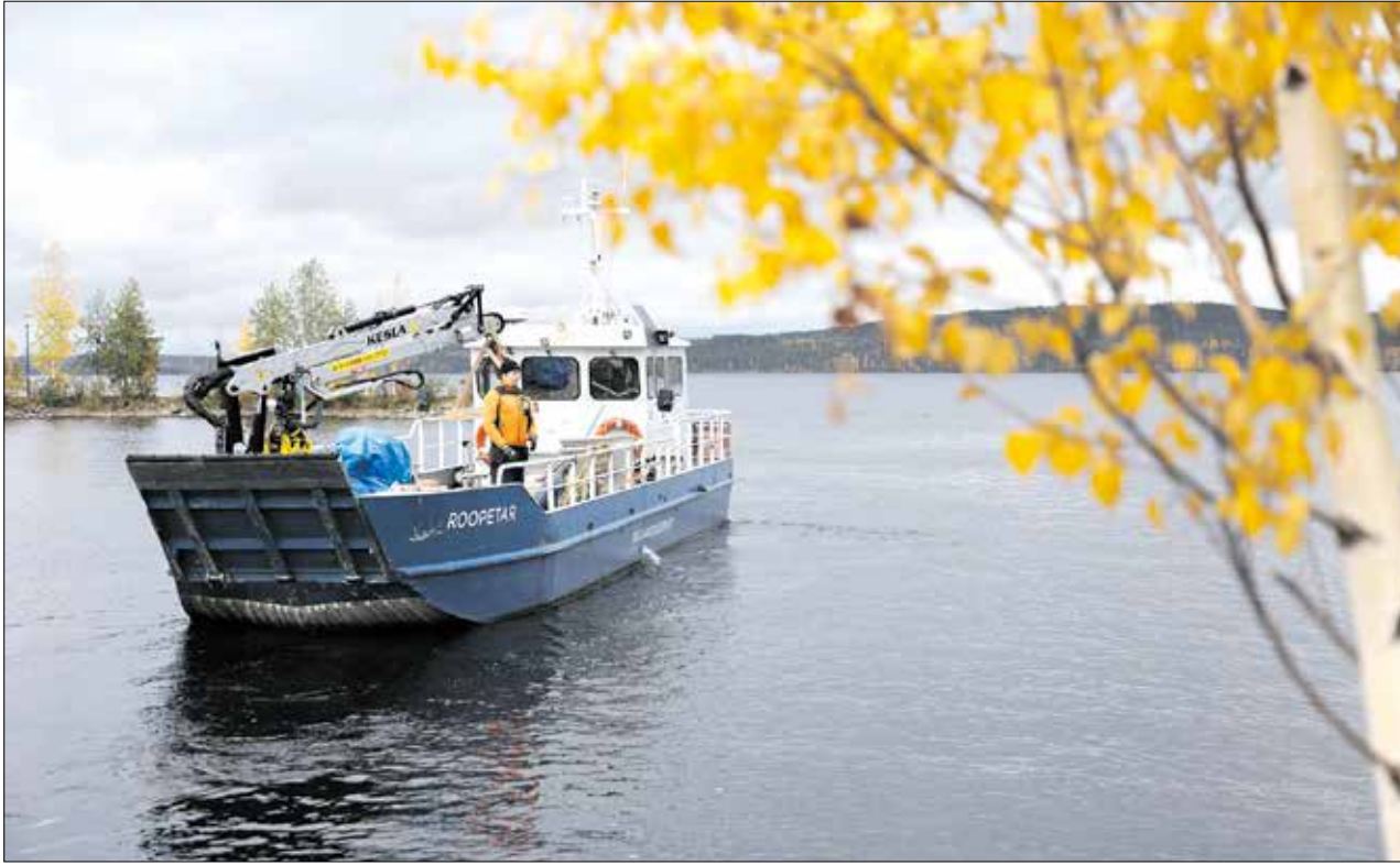
Nosturilla varustettu huoltoalus M/S Roopetar täyttää ensi vuonna 30 vuotta. Sen pituus on 16,5 metriä ja leveys 3,8 metriä. Kuvaja: Terhi Takkinen.
